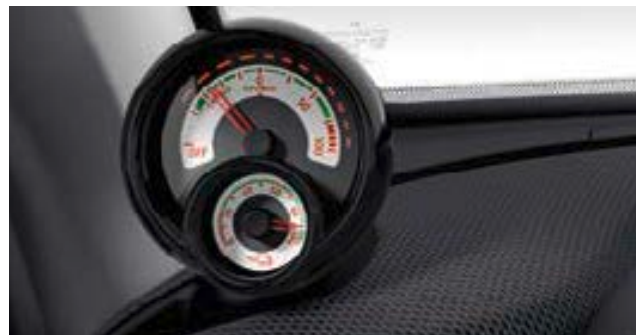
Zusatzinstrument (Batterieladezustands- und Leistungsanzeige) [V31]
