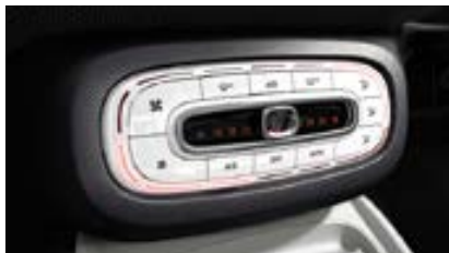
Klimatisierungsautomatik mit automatischer Temperaturregelung [I01]
