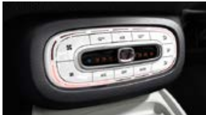
Klimatisierungsautomatik mit automatischer Temperaturregelung [I01]
