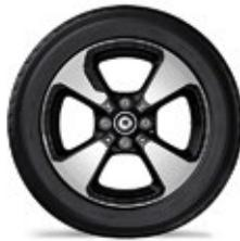
Leichtmetallräder im 4-Speichen-Design in schwarz lackiert und glanzgedreht, mit Bereifung vorn 165/65 R 15, hinten 185/60 R 15 [R32]
