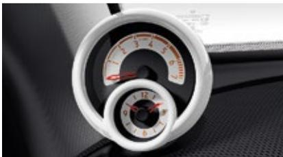
Zusatzinstrument mit Cockpituhr und Drehzahlmesser [V31]
